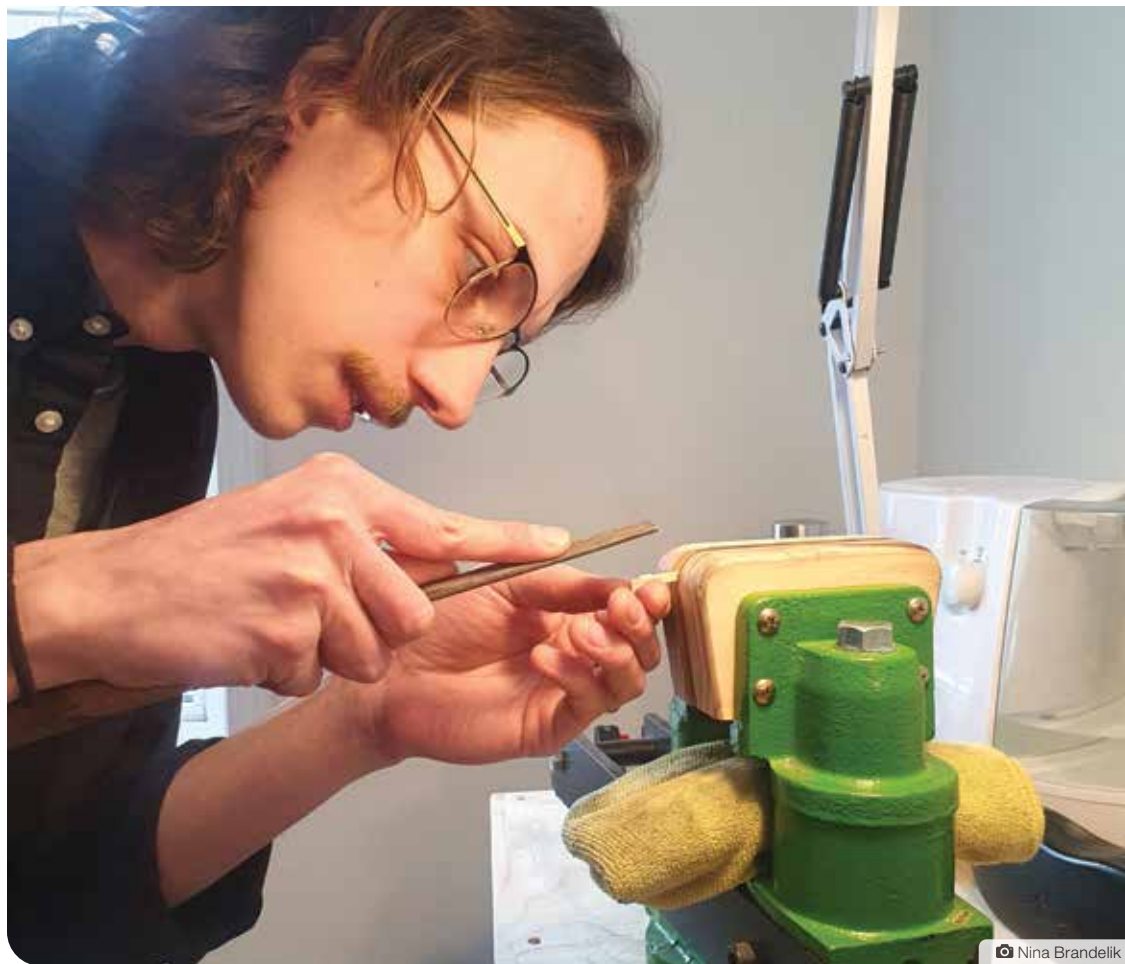
Jean Defontaine s'affaire à la réparation du sillet d'une guitare électrique.
