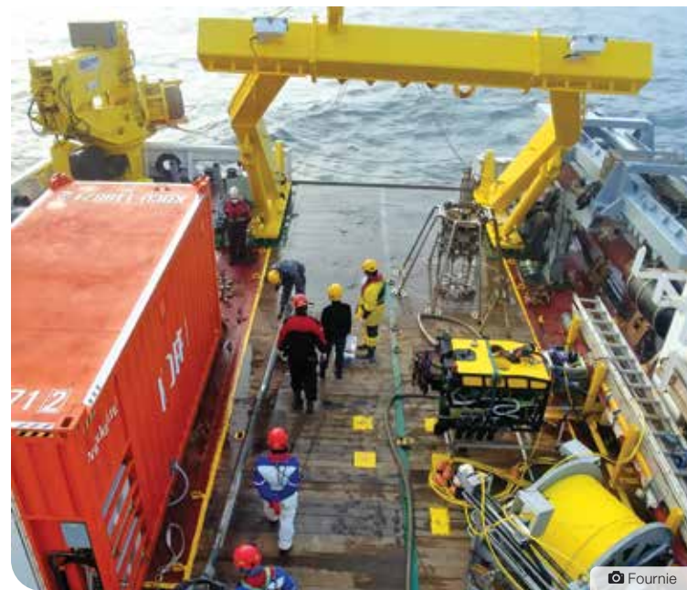
En préparation pour le déploiement du carottier pour l'échantillonnage de matériel géologique sous le fond marin.
