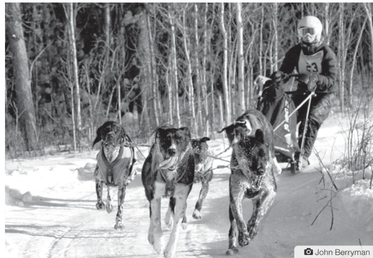
Dans les virages, avec la vitesse, un des patins du traîneau peut se soulever du sol. Cela explique pourquoi les traîneaux doivent être si flexibles.
