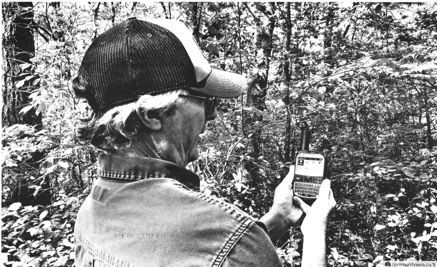
Kevin Callan, alias « The Happy Camper », apparaît ici avec un appareil de messagerie satellite bidirectionnelle SPOT X qui permet d'envoyer des alertes SOS en cas d'urgence. L'appareil permet aussi des communications fiables et bidirectionnelles pour la sécurité et la paix d'esprit de ceux qui s'aventurent hors de la portée des réseaux cellulaires.
