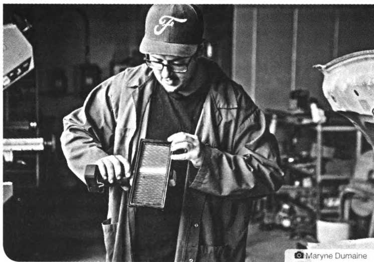
Pour savoir si le filtre à air de votre moteur est encore bon, il suffit d'utiliser une lampe de poche.
