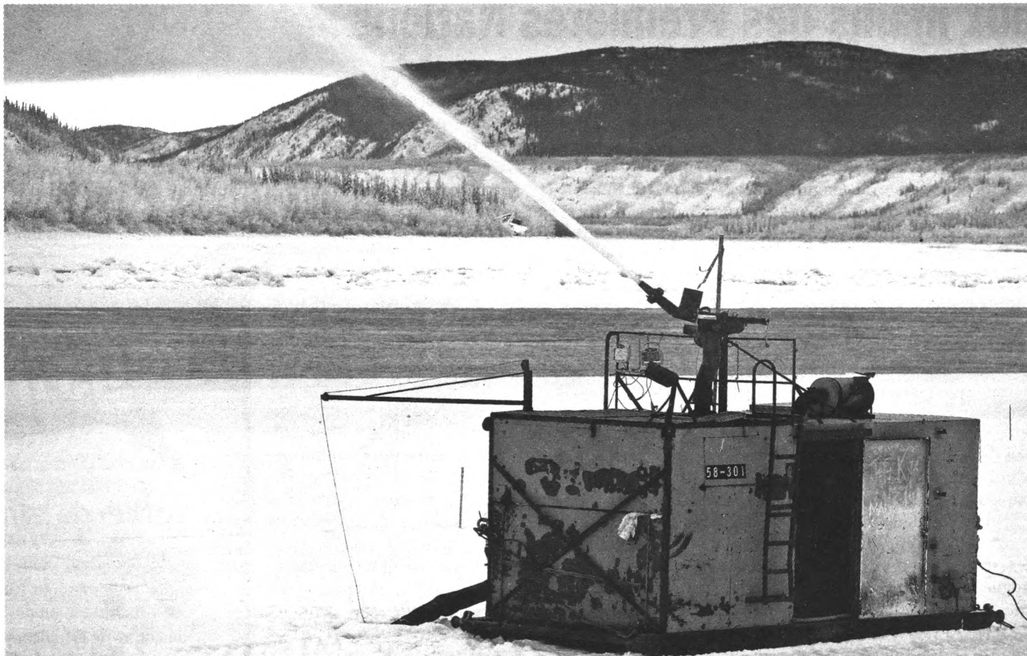
La machine utilisée peut pulvériser un brouillard de gouttelettes à une hauteur d'environ 30 m pour favoriser la formation de la glace.
