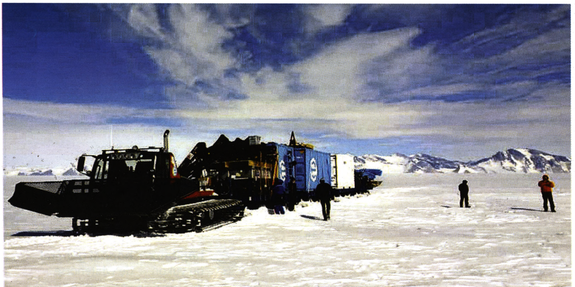
Le chasse-neige tire plusieurs conteneurs ainsi que le matériel nécessaire au forage distant de 200 kilomètres de la base belge.
