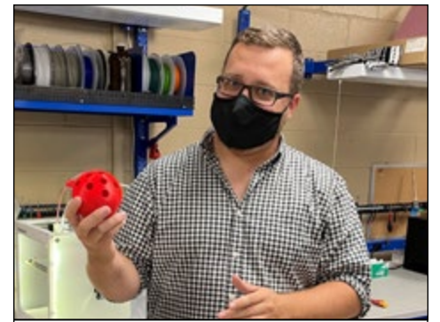
Michael Piercey, technologue à l'Université Memorial, montre à quoi ressemble la boule COSCa, utilisée pour faire échantillonner les eaux usées. Photo: Courtoisie Sandy Woolfred-Fahey
