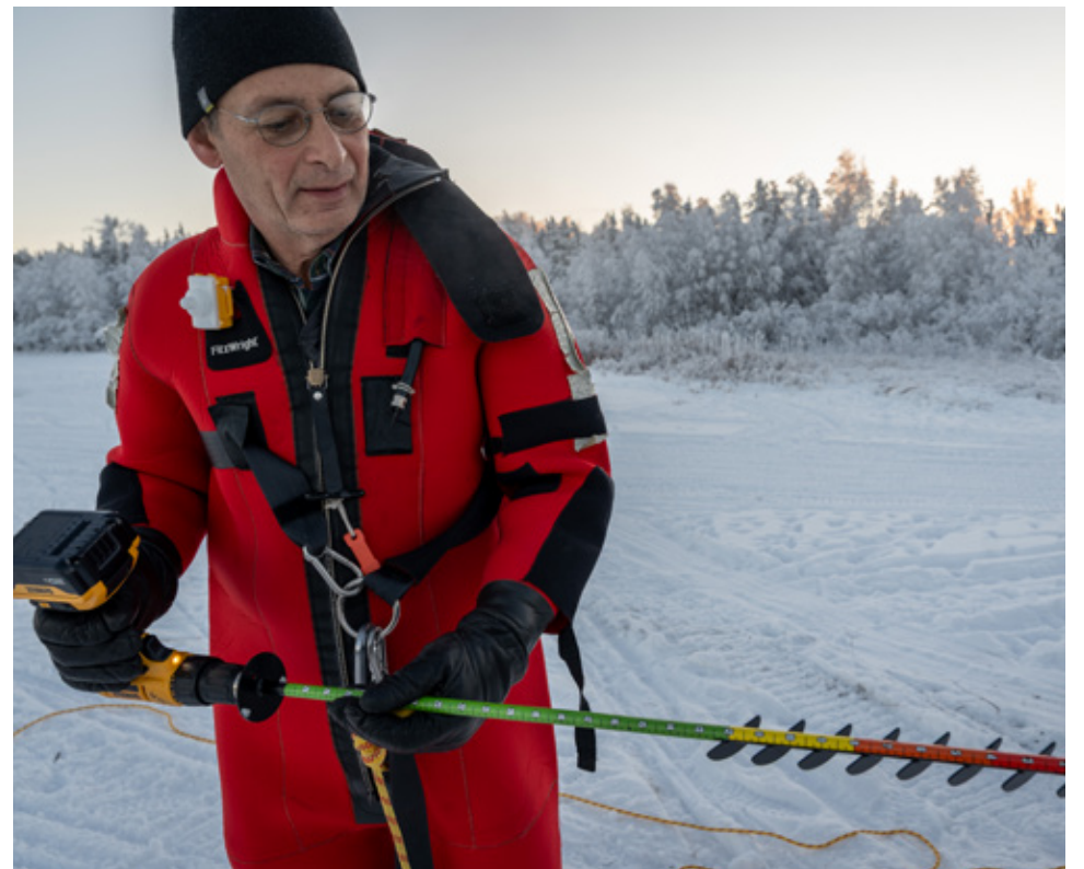
Sur la glace de Range Lake, Mike Burns présente le foret Jiffy , doté d'une échelle colorée qui indique l'épaisseur dès que le trou est percé. (Photo Cristiano Pereira)
